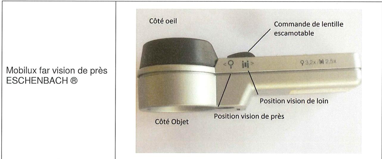
Cet instrument est composé d'une lentille mince  $L_1$  fixe et d'une lentille mince  $L_2$  escamotable (cf.photo ci-dessus).
