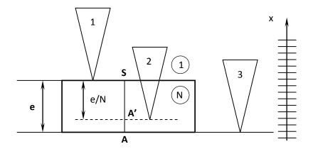
Le deuxième pointé revient à effectuer la mise au point du microscope sur l'image du second dioptre de la lame par rapport au premier.
