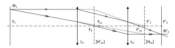
On constate que  $H_{oc}$  est en  $F'_1$  et  $H'_{oc}$ , en  $F_2$ .
