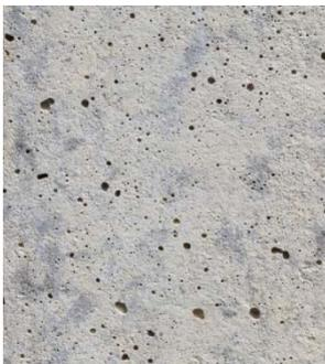
Béton ayant une teneur en eau proche de 250 kg par m<sup>3</sup> de béton
