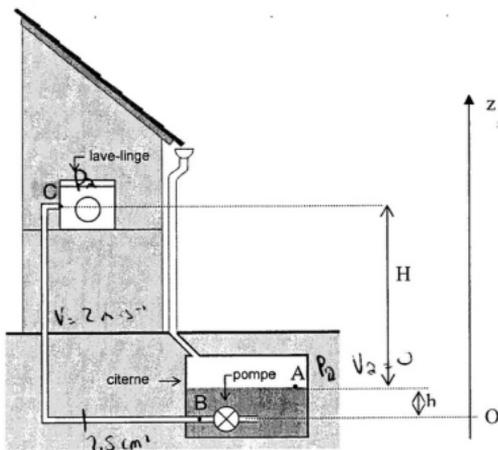
Le lave-linge est mis en marche et la pompe s'active alors pour remplir son réservoir. On suppose qu'aux points A et C l'eau est à la pression atmosphérique et que  $v_A = 0$ . La vitesse de l'eau dans la canalisation BC, dont la section est  $S = 2,5 \text{ cm}^2$ , est  $v = 2,0 \text{ m.s}^{-1}$ .
