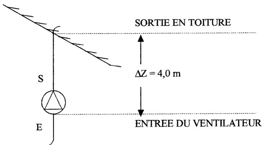
Le débit d'extraction attendu est  $Q_v = 1620 \text{ m}^3 \cdot \text{h}^{-1}$  pour une dépression totale assurée par le ventilateur égale à  $\Delta P = P_S - P_E = 240 \text{ Pa}$ .
