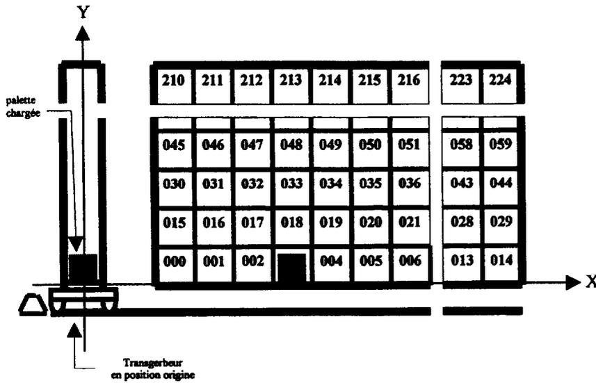
La version de base du magasin de stockage dynamique est donnée par la production maximale de la verrerie en poste de nuit, plus 10%.
