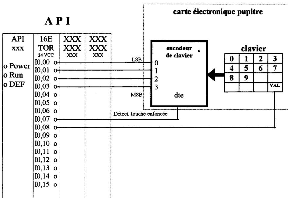
A l'issue de la saisie du troisième chiffre, les trois résultats codés en DCB (chiffre des centaines [c3 c2 c1 c0], chiffre des dizaines [d3 d2 d1 d0] et le chiffre des unités [u3 u2 u1 u0]) sont stockés dans trois mots W96, W97 et W98 de la mémoire de données de l'API.
