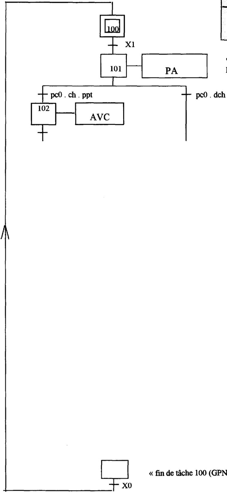
"PA" information lumineuse indiquant que le système est prêt à fonctionner
