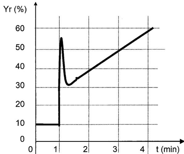
A l'instant  $t = 1$  min, un échelon de 20% est effectué sur la mesure
