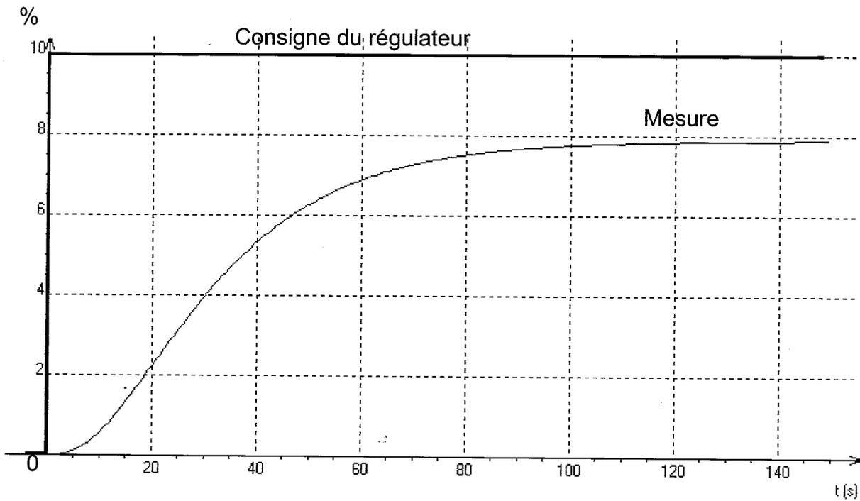
Oscillations de la mesure en boucle fermée avec le régulateur en action proportionnelle pur (P)
