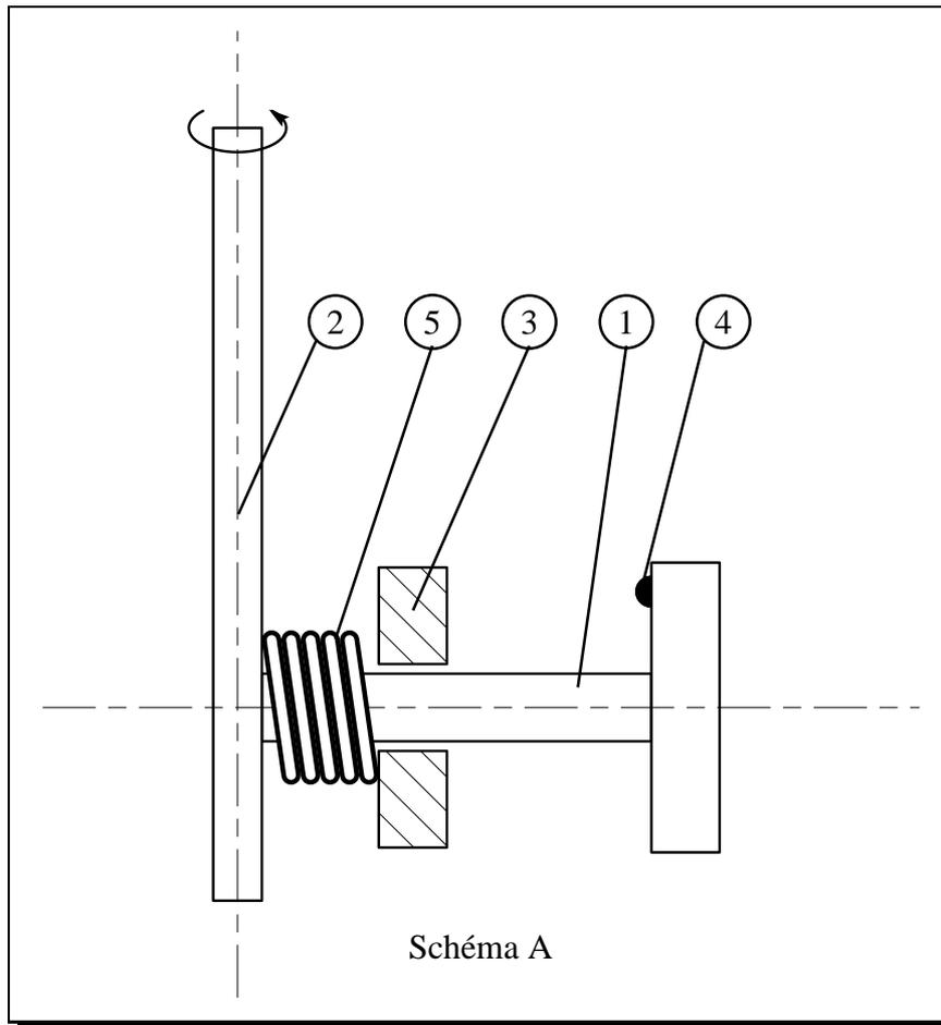
Une tige horizontale (1) de longueur  $\ell$  est solidarisée perpendiculairement à un arbre (2) d'une machine tournant à une vitesse angulaire constante  $\omega$ . Un ressort (5) de constante de raideur  $k$  est fixé par l'une de ses extrémités à l'arbre et par l'autre à un solide (3) de masse  $M$ , qui peut coulisser sans frottement sur la tige. Si le solide arrive en butée, il actionne un capteur (4) qui déclenche l'arrêt de la machine (voir schéma A).
