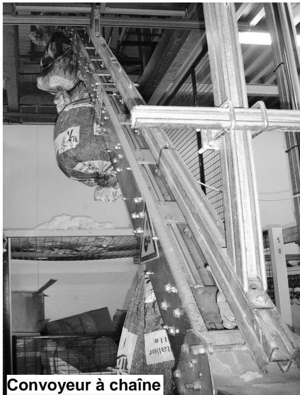
Pour rejoindre le poste de tri situé à l'étage supérieur, les sacs de linge sale sont acheminés par un convoyeur à chaîne fonctionnant en continu.
