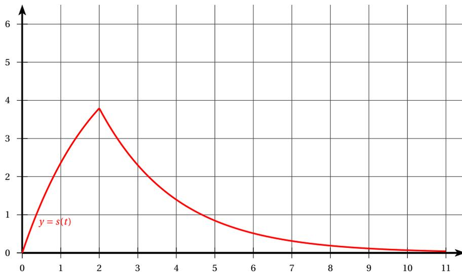
b. Dans un premier temps, lorsque la tension à l'entrée est de 6V, le condensateur se charge. À  $t = 2$ s, lorsque la tension à l'entrée devient nulle, le condensateur se décharge progressivement dans le circuit.
