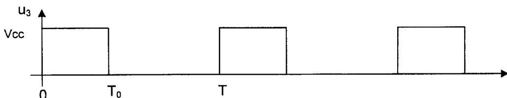
On précise que la durée propre du monostable est  $T_0 = 33,3 \text{ }\mu\text{s}$ .
