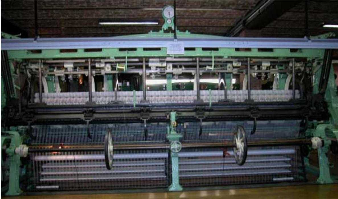
Ces métiers sont constitués, entre autres, de chariots Leavers, pièces en acier animées d'un mouvement de balancier et sur lesquels se déroule le fil. On peut ainsi trouver jusqu'à 5 000 chariots Leavers sur un métier.
