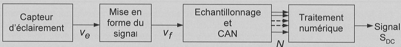
La carte électronique gérant la fonction « contrôle de luminosité » transmet un signal  $S_{DC}$  à la carte maître dans le but de modifier la luminosité des pixels en fonction de l'éclairement lumineux (**documentation SP3**).
