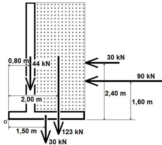
Calculer le coefficient  $f$  et conclure sur le prédimensionnement du mur retenu vis-à-vis du risque de renversement.
