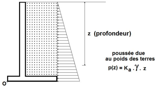
1.6) Le schéma mécanique retenu avec les charges pondérées aux ELU est le suivant :
