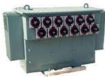
Aussi appelé transformateur à huile, le transformateur d'injection de fréquence (TIF) immergé dans l'huile minérale, installé dans le poste source HTB/HTA en extérieur, permet l'injection de signaux de télécommande
