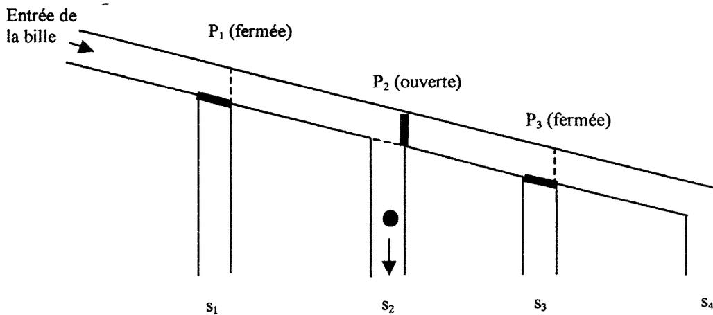
NB: sur le schéma les portes  $P_1$  et  $P_3$  sont fermées, la porte  $P_2$  est ouverte, la bille sortira par  $s_2$ .
