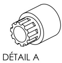
Embout stop bague, collé dans le rayon
