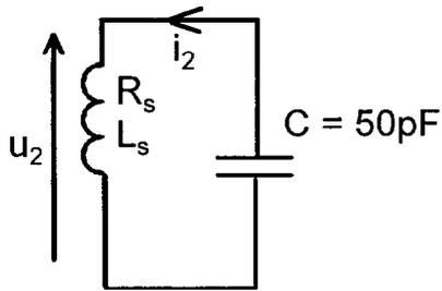
C est la capacité parasite présentée par le circuit secondaire. (Rappel :  $1\text{pF} = 1 \times 10^{-12} \text{ F}$ ).
