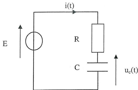
2-1– En appliquant la loi d’additivité des tensions, **établir** l’équation différentielle d’inconnue  $u_c(t)$  modélisant la charge du condensateur.
