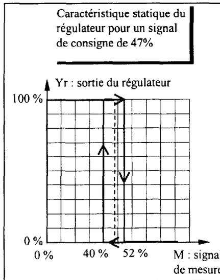
Représenter sur le document réponse DR3 le signal de commande  $Yr(t)$  en concordance avec le signal de mesure  $M(t)$ .
