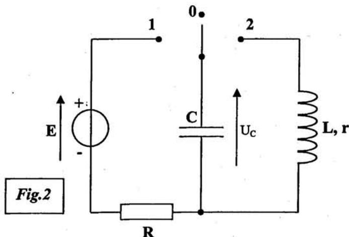
Le circuit de charge (**Fig.2**), outre le condensateur de capacité  $C$ , est constitué d'un conducteur ohmique de résistance  $R$  et d'un générateur idéal de tension de force électromotrice  $E = 8,0 \text{ V}$ .
