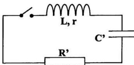
L'évolution de la tension aux bornes du condensateur a été enregistrée à la fermeture de l'interrupteur, elle figure sur le **graphique n° 3 de l'annexe page 10**.
