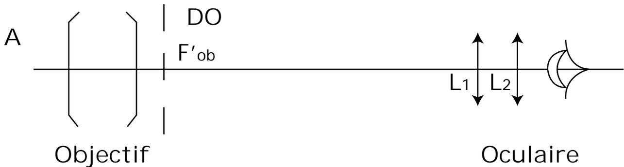
L'instrument est réglé pour donner d'un objet AB, une image  $A'B'$  à  $l'∞$ . La pupille d'entrée de l'œil de l'observateur, de diamètre 3mm, est située dans le plan du cercle oculaire de l'instrument.
