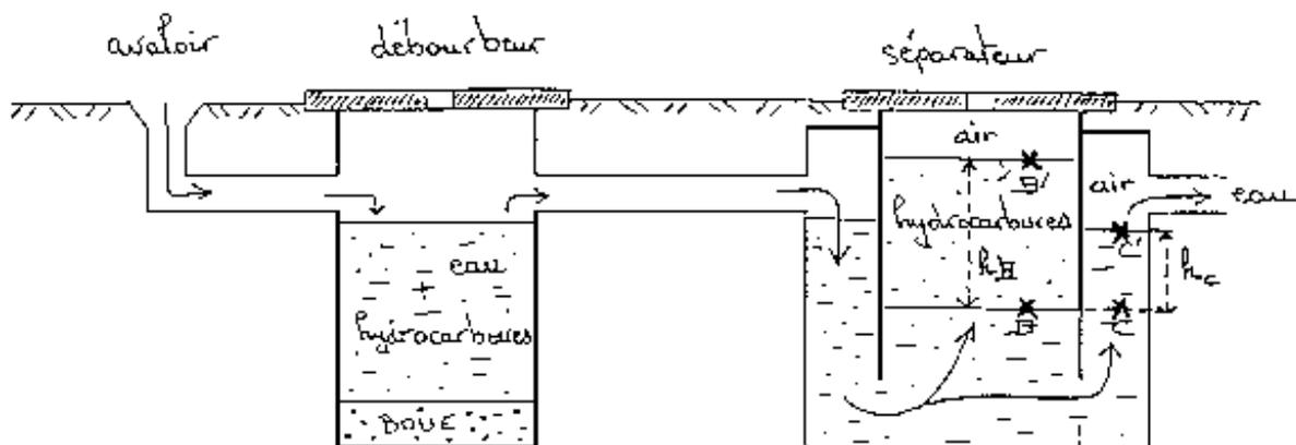
L'eau est récupérée par un avaloir de sol puis passe par un déboureur qui permet de retenir la boue par décantation. Le mélange eau + hydrocarbures se dirige ensuite vers un séparateur où les hydrocarbures moins denses que l'eau sont isolés et peuvent être récupérés. La capacité totale du déboureur est 160 L et sa surface de base est un carré de 0,32 m<sup>2</sup> de surface.
