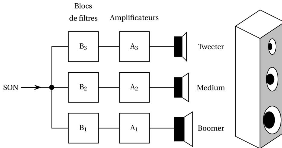
**Dans l'exercice, on étudie un des blocs de filtres utilisés. Il est constitué de deux filtres  $F_1$  et  $F_2$ .**
