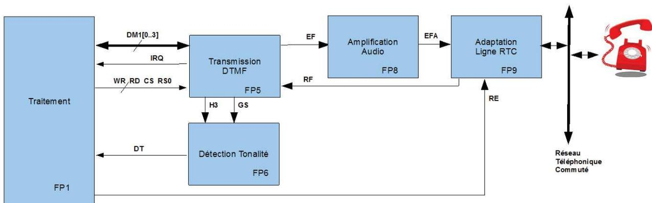
**DT** : signal de détection de tonalité. Il y a détection lorsque ce signal est au niveau logique haut,
