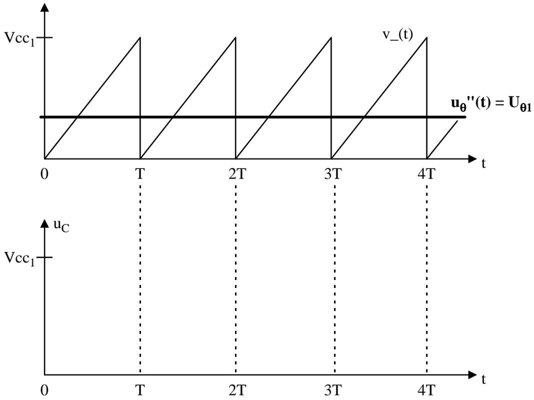
Figure 4 : chorogrammes de  $v_-(t)$  et  $u_{\theta}''(t)$
