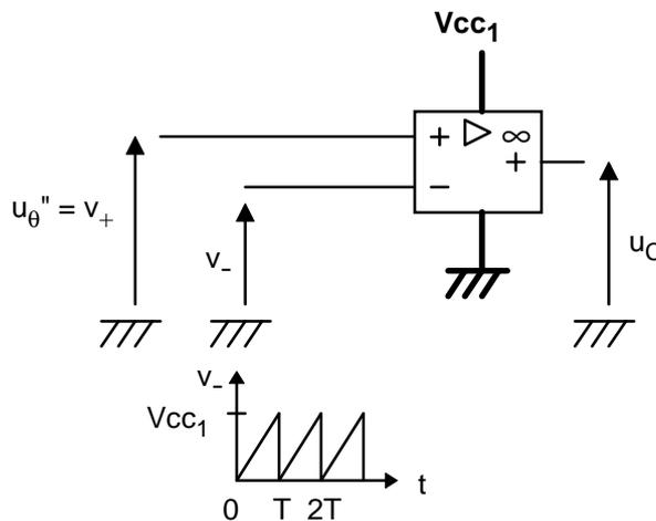
Figure 3 : principe du modulateur
