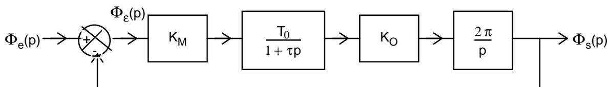
Figure 9 : Schéma d'une boucle à verrouillage de phase
