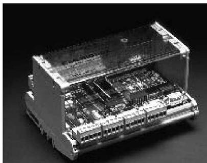
2. La famille d'équipement **DIOCOM** de la société LUTZE permet de réaliser des systèmes autonomes d'acquisition de données connectés sur un réseau de terrain ProfibusDP. Leurs principales caractéristiques sont les suivantes :
