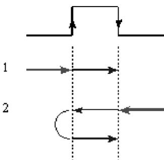
Le système est basé sur la détection des fronts montant et descendant lors du franchissement d'un capteur. Lorsque le robot doit effectivement s'arrêter sur le capteur, la détection du front montant provoque le cas échéant une réduction en PV, jusqu'à obtention du front descendant du même capteur.
