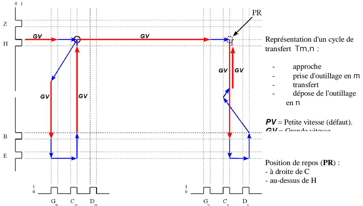
**Note** : Les trois mouvements obliques sont des mouvements combinés ; petite vitesse (PV) sur l'axe horizontal et grande vitesse (GV) sur l'axe vertical.
