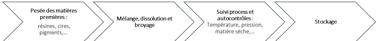
Tout **non-respect des modes opératoires** (température, temps de mélange ou de broyage) engendre quasiment systématiquement une baisse du **niveau de qualité de l'encre** et par conséquent du rouleau jusqu'à la **non-conformité**, le rebut voire la **réclamation client**.
