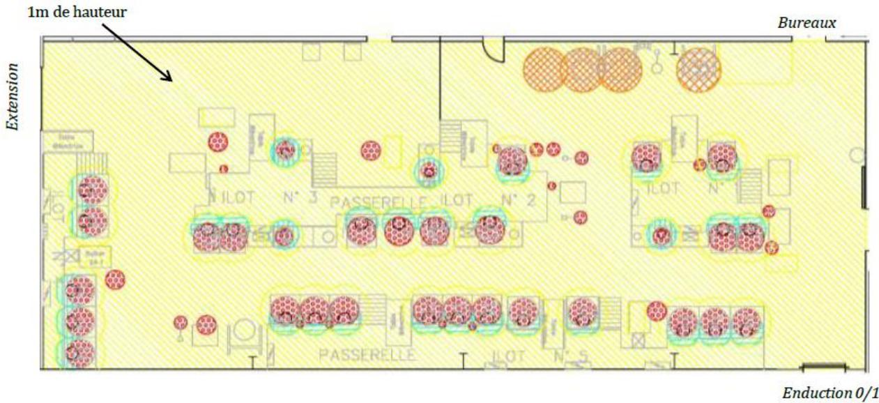
Le schéma suivant représente un plan de coupe du matériel et les différentes zones ATEX de chacun d'eux.
