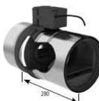
Registre avec volet plein équipé d'un régulateur permettant d'obtenir 10% du débit nominal en position fermée. En position ouverte, un manchon autoréglable installé en amont du registre régule le débit nominal.
