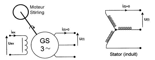
Le rotor de l'alternateur tournant à 750 tr/min, on relève sur un oscilloscope, la tension u(t) entre 2 phases de l'induit pour un fonctionnement à vide (i(t)=0):
