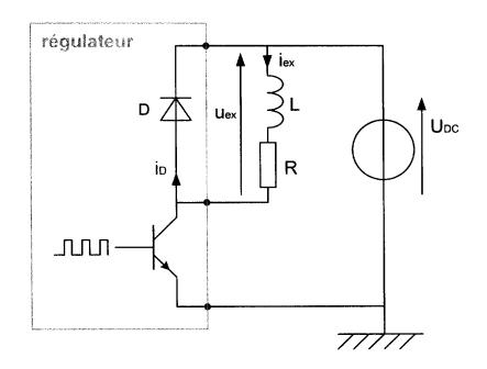
La tension  $U_{DC}$  est issue du redressement de la tension de sortie de l'alternateur ;  $U_{DC}$  est considérée comme constante de valeur  $u_{DC}(t)=U_{DC}=14$ V. L'inducteur est modélisé par le circuit inductif d'inductance L et de résistance R, de la figure. Un relevé de l'intensité  $i_{\rm ex}(t)$  du courant traversant l'inducteur est donné sur le document réponse. La mesure de sa valeur moyenne donne :  $< i_{\rm ex}(t) >= 24,40$  A.
