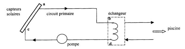
L'eau du circuit primaire arrive dans l'échangeur à une température  $\theta_1$ = 60 °C et sort de l'échangeur à une température  $\theta_2$  = 40 °C.
