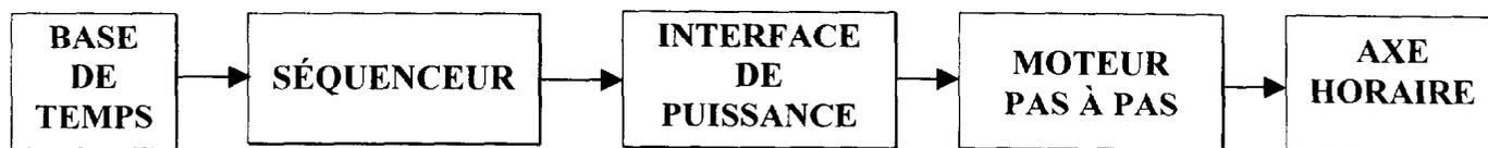
La **base temps** est constituée par un oscillateur astable : elle délivre un signal logique de fréquence proportionnelle à la fréquence de rotation du moteur pas à pas.
