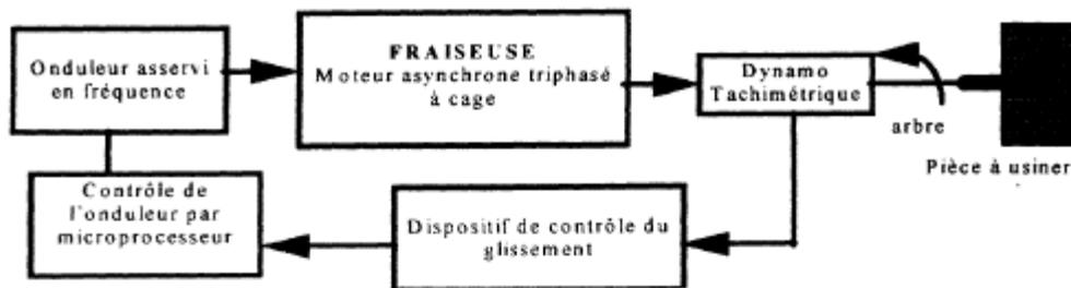
On se propose d'étudier le fonctionnement simplifié d'une fraiseuse pilotée par ordinateur. Le système étudié comporte les éléments suivants:
