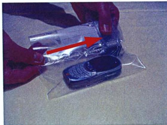
On pince la poche près du bord, on attend environ une seconde que la « résistance chauffante » soit montée en température, puis on tire l'appareil et/ou la poche pour réaliser la soudure. Il faut ensuite faire une reprise sur le premier bord pour terminer la fermeture de la poche.
