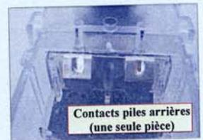
Les « contacts piles arrières » sont en une seule pièce (pièce découpée, cambrée, emboutie), tandis que les « contacts piles avants » sont en deux pièces. Les piles étant montées tête-bêche, la tension obtenue est de 3V.
