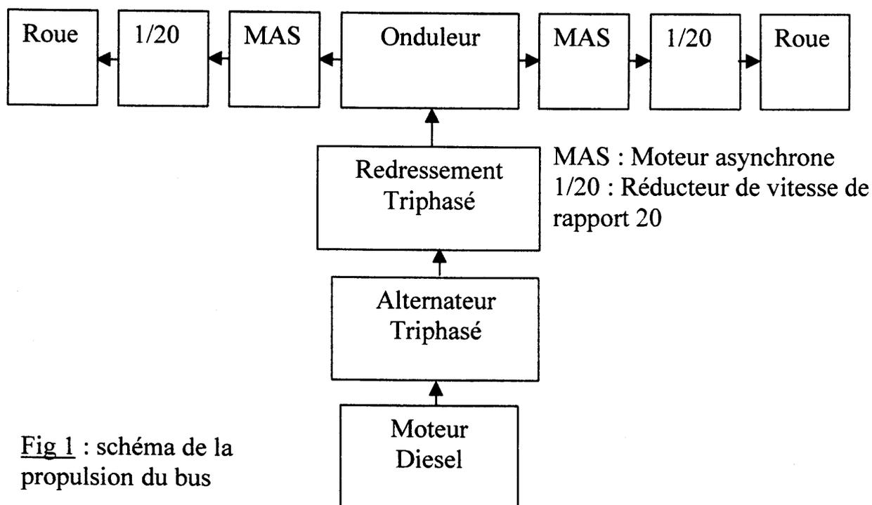
Fig 1 : schéma de la propulsion du bus
