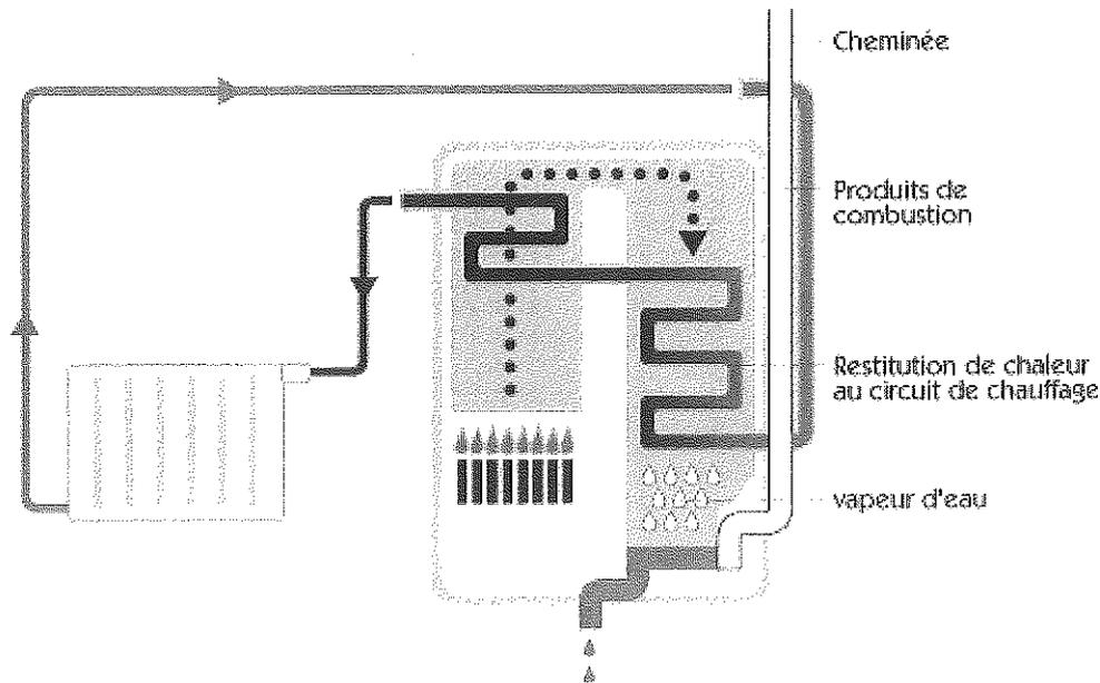
Lors de la mise en marche de la chaudière à condensation, le circuit d'eau est réchauffé par le brûleur de gaz naturel. La combustion du gaz émet des fumées à haute température qui seront valorisées lors du processus de condensation. Ces fumées sont constituées essentiellement de diazote  $N_2$ , de dioxyde de carbone  $CO_2$  et d'eau  $H_2O$ .
