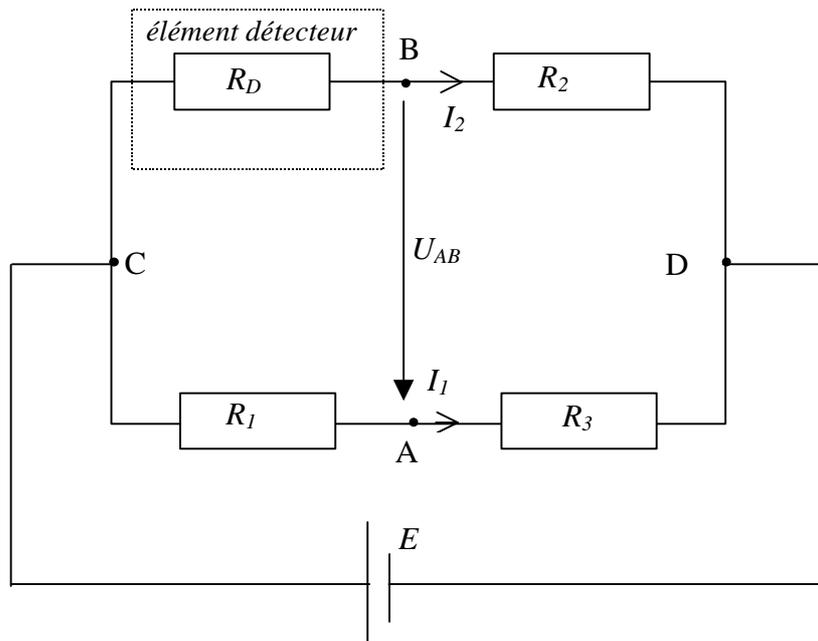
1. On procède à l'équilibrage du pont en présence d'air pur à 20,0 °C. Établir la relation liant alors  $R_1$ ,  $R_2$ ,  $R_3$  et  $R_D$  quand le pont est équilibré (c'est à dire lorsque  $U_{AB} = 0$ ). Que devient cette relation si  $R_2 = R_3 = R$  ? (on gardera cette égalité dans le reste du problème)
