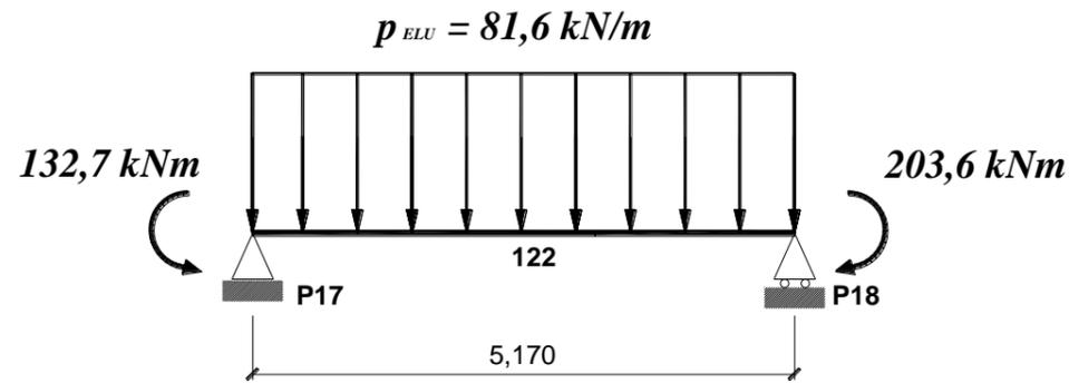
⇒ Sur le **DR1**, tracer précisément le diagramme de moment fléchissant dans la travée 122.
