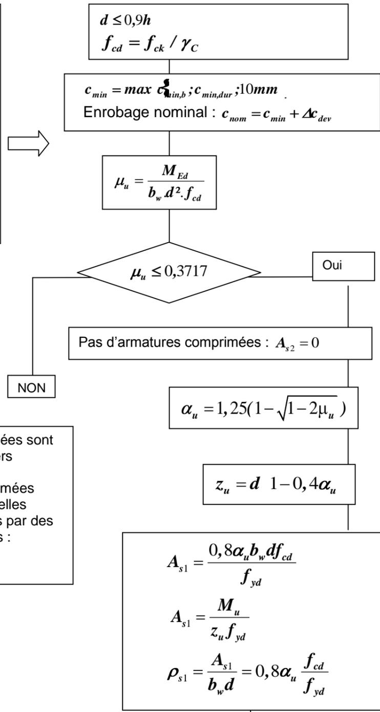
Les armatures comprimées sont conseillées, car les aciers seraient mal utilisés. Si les armatures comprimées sont prises en compte, elles seront alors maintenues par des armatures transversales :  $s \leq 15\phi$ .
