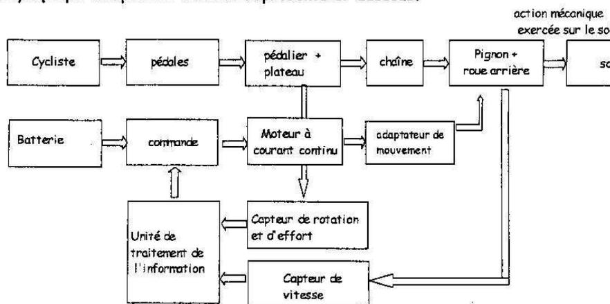
On se propose d'étudier : la mesure de la vitesse, le moteur et sa commande.
