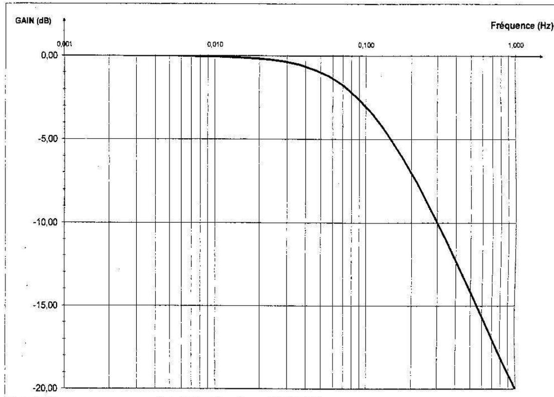
1.3.4. Que peut on dire de  $u_3$  si on suppose que le filtre ne laisse pas passer les harmoniques de fréquences supérieures à  $f_h$  ?
