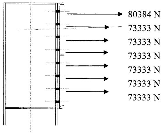
c) Vérifier la résistance de l'assemblage au moment fléchissant  $M$
