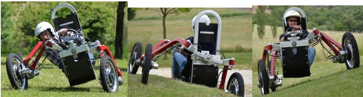
Fig. 2 : E-SPIDER effectuant un virage et en position de dévers
