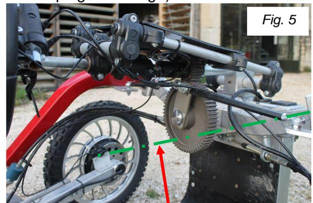
Axe de commande de la direction = axe longitudinal
