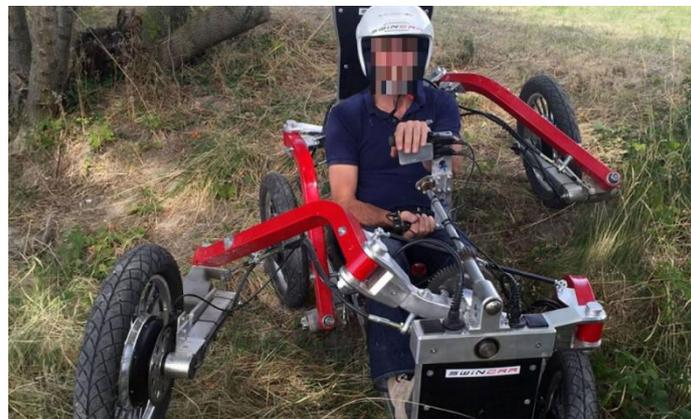
Fig. 3 : franchissement de fossé appelé également franchissement de « pont »
