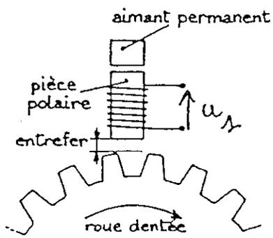
Principe du tachymètre à réluctance variable.
