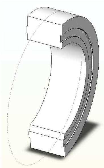
*Figure 5 : Image d'un segment standard de laminoir (segment de 175°)*
