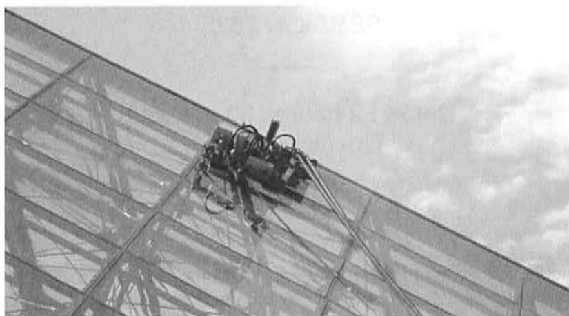
**Figure 1 : robot nettoyeur Robuglass vu de l'extérieur**
